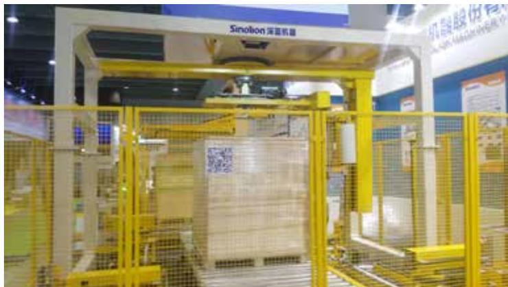
本设备是将拉伸膜自动缠绕到托盘货物上的专用设备。对货物起到防尘、防潮、防散货的包装作用，从而起到了对产品的保护、节约包装成本、降低工人劳动强度、提高包装效果的专用设备。
