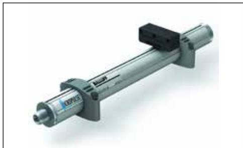
效替代方案，BML 磁编码式绝对位置测量系统可以帮助精确地控制电机和驱动器。“在快速运动场合下，BML 通过高精度和高准确性绝对位置反馈定位，大大帮助我们的设备提高了加工品质，节约了资源。”洪富机械相关负责人认为，“分辨率高达  $1\ \mu\text{m}$  的 BML 轻松胜任面皮厚度误差精度要求，而且 IP67 的高防护等级坚固设计和非接触式测量方式让其免维护，从而大大降低了食品污染的风险。”
