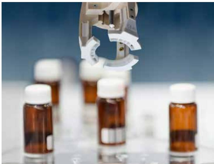
图4 由耐磨优化材料 iglidur I150 制成的 3D 打印塑料夹具能为包装设备节省 85% 的成本和 70% 的生产时间。
