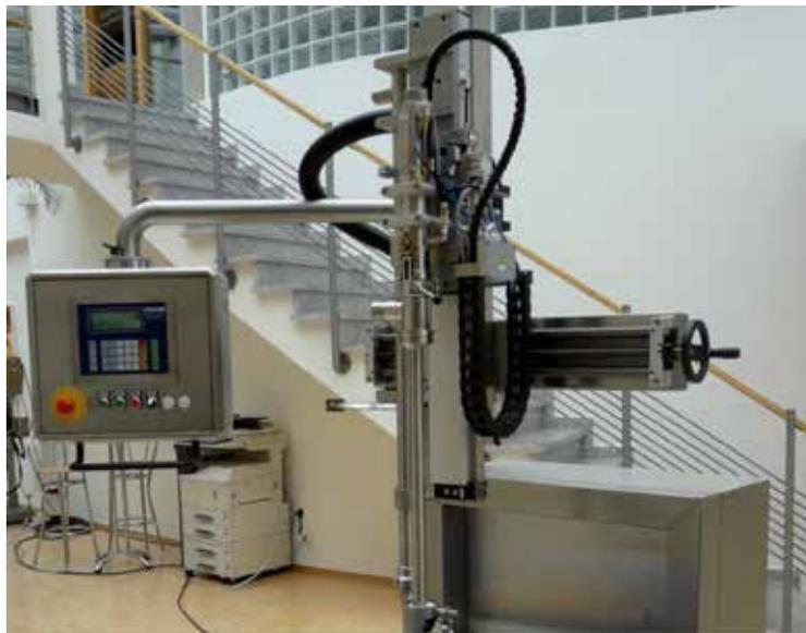
图2 Fricke在其设备的灌装头中使用了免润滑且耐磨损的drylin SLW直线产品系列组成的丝杆升降模组，来提高设备性能并降低成本。
