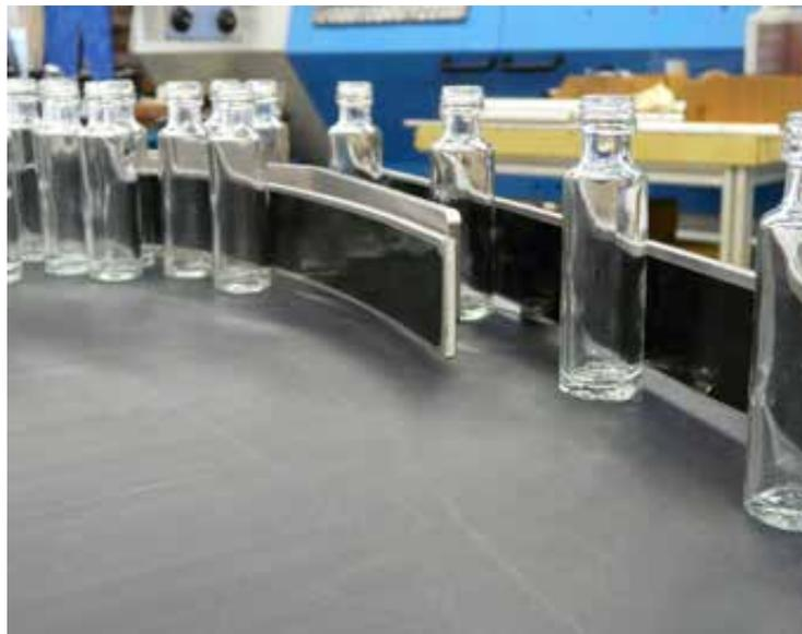
图3（由 iglidur B160 材料制成的）igidur 耐磨带条用于 Küppersbusch 装瓶设备旋转台的出口位置。
