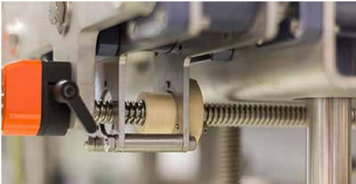
图1 克朗斯Sleevematic TS套标机中使用了igidur J梯形法兰螺母。
