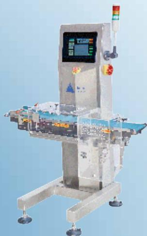
高精度检重秤适用于盒装药品检测及对精度要求极高的小型产品使用。如对质量要求严格的药品及其他生物物品、塑料五金零部件等。专门针对小型物品称重，研发、制造。该设备的最高显示精度（分度值）为 0.01g，最高选别精度为  $\pm 0.05g$ 。机器的程序及管理系统齐全，拥有 CE 认证。且高度上下可随意调节，不受现场流水线高矮限制。
