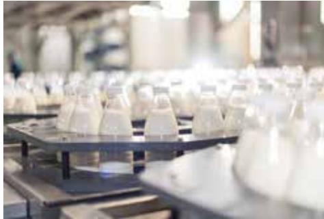
这条克朗斯PET瓶生产线适用于冷无菌灌装低酸和高酸产品。
