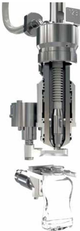
5、灌装阀本身由阀体和内部阀锥组成。灌装时,这个单元可降低到接近瓶口。此时,负责阀门开启和关闭的阀锥单独控制,借此改变灌装速度。对于不同的产品,可以根据相应的产品特性最佳地调整阀锥的灌装和关闭速度,保证最高的灵活性。
