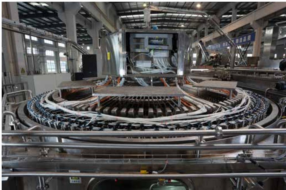
的接触和服务，“当年新美星的灌装设备还处于发展阶段，主要采用了费斯托符合国际 FDI 认证的气管接头产品，用于替代不锈钢管。随着灌装设备技术的发展，新美星逐渐开始采用组件阀岛”，刘东表示，“双方的合作从初级阶段的常规灌装设备，到无菌线设备，再到第三个阶段吹瓶机设备。”
