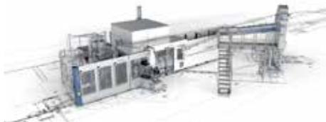
克朗斯的 ErgoBloc 四维一体组合机，拉伸吹塑 - 贴标 - 灌装 - 封盖一气呵成，完美的实现了小空间内的多种机型排布，以湿区组合机器为例，每小时产量高达 81,000 个容器，并且与传统机器相比，所需空间最多可以减少 70%。该组合机能够做到 PET 容器的无损处理，输送夹具仅接触预坯和瓶子的颈部区域，最小化的减小材料和机器的接触面积。此外，从伺服驱动器到电磁无压缩空气拉伸系统，极大的节约了能耗。四个流程步骤，仅需一名操作员工。🔗
