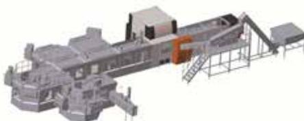
新美星研发的集吹瓶、包材消毒、灌装及旋盖解决方案于一体的无菌吹灌旋一体机，具有完善的包装卫生条件，完整的灭菌工艺，通过完整的隔离区域保障了液体包装过程中的无菌状态，为高酸性产品和低酸性产品提供最完美的包装服务，以及卓越的健康品质和营养好味道。该设备目前已在盼盼集团、维维集团旗下的品牌工厂投入使用，深受好评。
