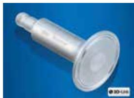
PP20H 卫生型压力变送器采用防护等级为 IP69K 的坚固不锈钢外壳，并配备抗冷凝压阻硅测量芯体，能轻松应对各种应用。该变送器的压力测量范围为 -1-40bar，并兼容多种过程连接，应用范围极其广泛。此外，它还提供 4-20mA 信号输出和 IO-Link 接口，满足食品和制药行业严苛的卫生要求，并适用于 CIP（现场清洗）和 SIP（现场灭菌）过程。
