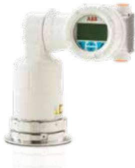
LLT100 是 ABB 的新型激光物位变送器，专门为工业应用而设计，它将高精度激光测量的优点带给了工业应用的严酷环境。由于激光束在传播过程中可以保持狭窄，因此即使在有限的空间中，光束也不会与罐壁发生碰撞。即使在距离如 15 米的地方，光束也不到 10 厘米宽，所以它可以很容易地穿过拥挤的容器中的小开口。这也使得测量不受罐中侧壁堆积的影响，因此罐内测量没有多个回波需要过滤、优化处理。这在食品和饮料行业的典型应用中也是有益的：例如用于有搅拌器或混合容器中的测量。
