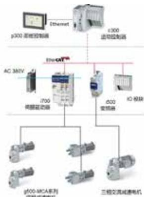
图2 Lenze 在热成型机的中端解决方案。
