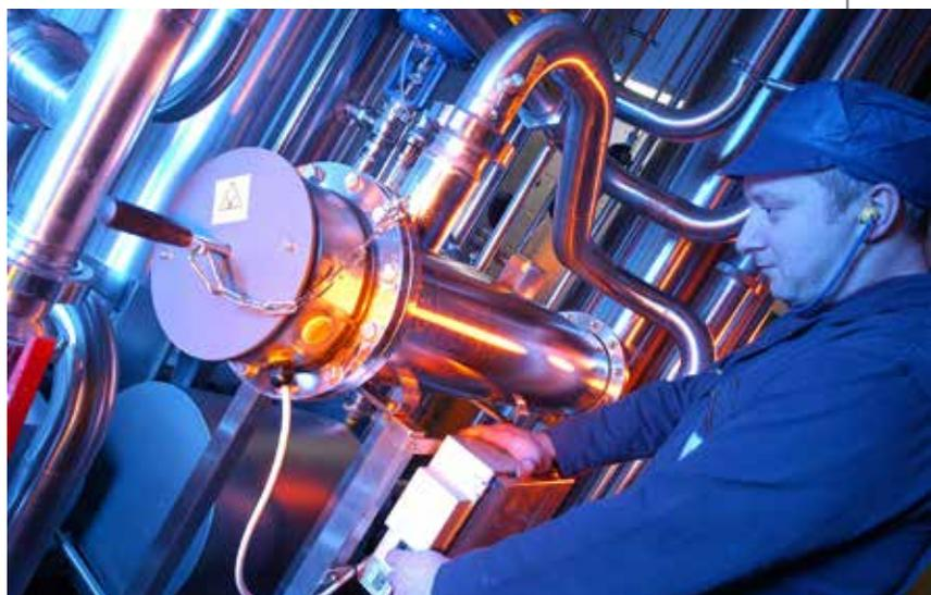
还没有微生物可以抵抗紫外线，包括李斯特菌、军团菌、隐孢子虫(及其耐氯化的孢子)等病原菌。由于紫外线没有残留影响，因此安装处理系统的最佳位置是在即将使用液体之前。这可以确保微生物污染物被顺利清除，而且出现处理后污染的几率很小。
