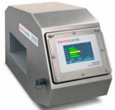
独特设计的 Sentinel 金属探测器适用范围广，在乳制品、肉类、家禽、水果、蔬菜、面包、健康和美容等产品检测方面表现非同凡响。检查这些产品是否有异物特别富有挑战性，因为所谓的产品效应（即来自特定类型金属的信号）可能会隐藏在产品电磁效应中。传统技术，只能通过选择不同频率金属探测器让隐藏的金属变得可以检测，但是不能同时检测到隐藏的不同类型更小的金属异物。赛默飞世尔科技设计的 Sentinel 通过扫描多个频率解决了这一难题，从而提高了发现所有物理污染的金屬异物随机尺寸、形状和类型的能力。
