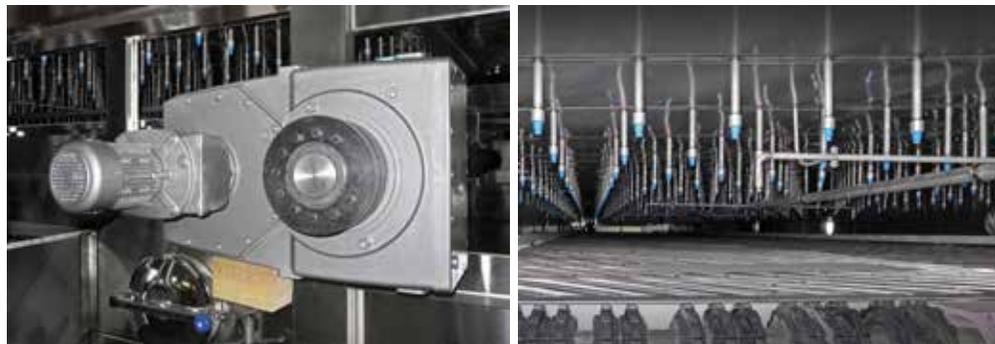
图 2, 3 带输入级 (上) 的平行轴斜齿轮减速电机可驱动冷却通道 (下) 中的输送机, 它还含有低维护的 Gripmaxx 套管。
