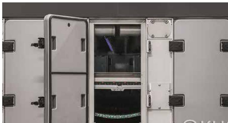
通过侧边可打开并拆卸的锁定绝缘元件，操作者可以很容易地探入管道内部。
