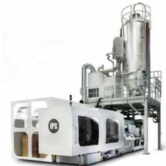
解决现有问题锁定了方向，其特点能与吹瓶、灌装和贴标设备完美连线，针对瓶盖和瓶坯加工过程实时同步，节省生产时消毒成本和厂房的物流成本。
