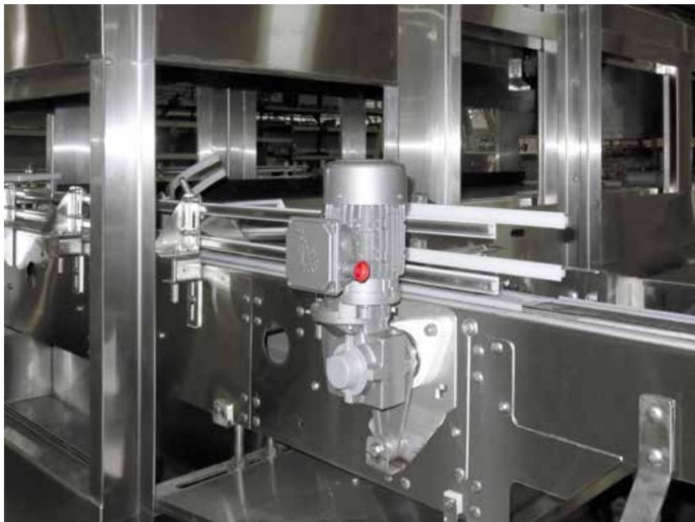
图1 分瓶时无瓶颈——灵活的斜齿轮蜗轮蜗杆减速电机可防止堵塞。
