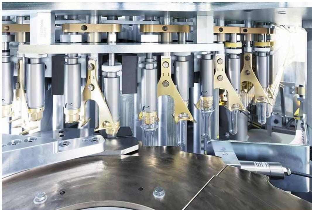
InnoPET Blomax V第五代拉伸吹瓶系统：具备高效和可靠性能的系统，源自于其全新的加热理念。与其上一代产品相比，InnoPET Blomax V第五代吹瓶系统可节省40%能耗。
