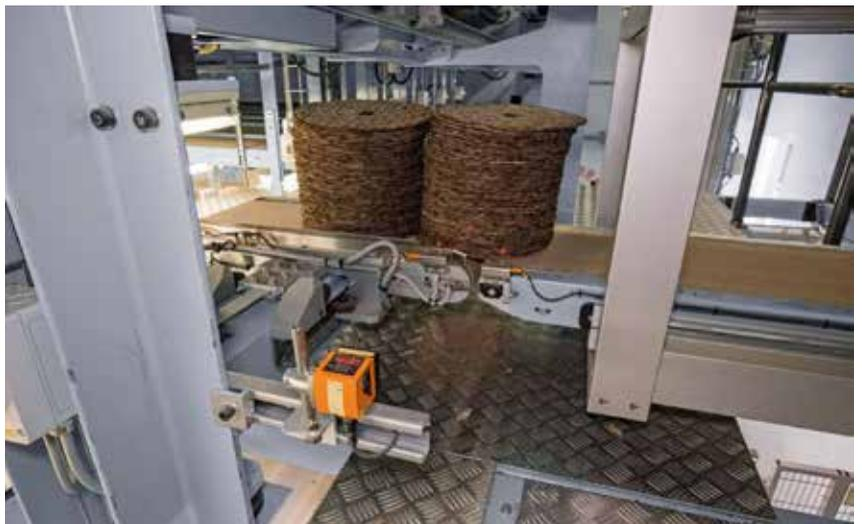
针对位置检测的远距离测量：OID采用光飞行时间技术。
