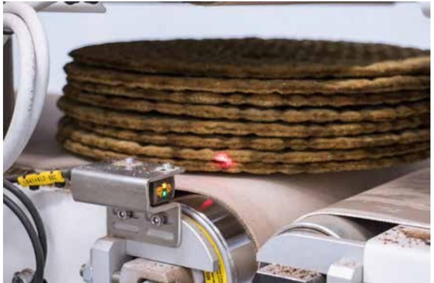
ifm O6系列漫反射光电传感器监测物料流动。
