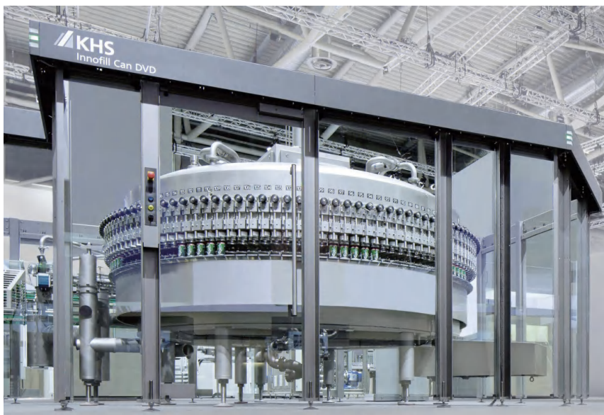
KHS InnoFill Can DVD 高速易拉罐灌装设备
