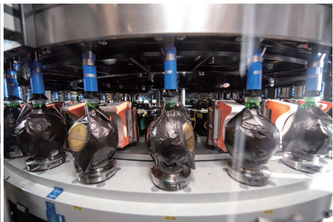
固定铝箔采用一种已申请专利的解决方案：一台伺服电机转动瓶子，由直线电机利用海绵将铝箔压在瓶子上。
