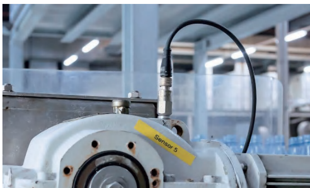
驱动系统上的振动传感器甚至可以检测到极弱的振动。
