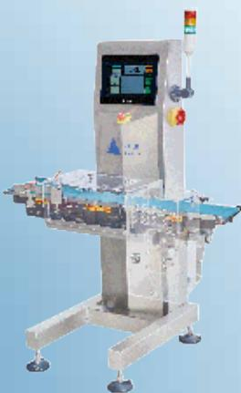
高精度检重秤适用于盒装药品检测及对精度要求极高的小型产品使用。如对质量要求严格的药品及其他生物物品、塑料五金零部件等。专门针对小型物品称重，研发、制造。该设备的最高显示精度（分度值）为 0.01g，最高选别精度为  $\pm 0.05g$ 。机器的程序及管理系统齐全，拥有 CE 认证。且高度上下可随意调节，不受现场流水线高矮限制。
