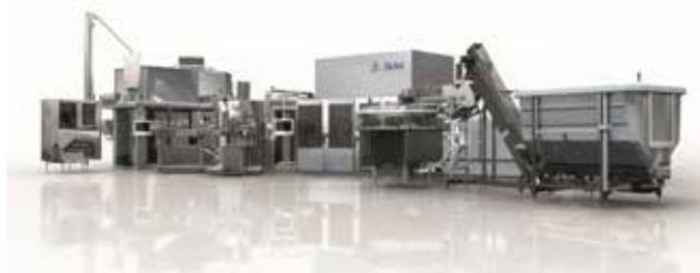
西得乐高速包装水生产线，整合了吹瓶、灌装、旋盖功能，使超轻 PET 和 rPET 瓶从吹瓶灌装到旋盖一气呵成，实现了明显的空间与生产成本的节约。西得乐专利智能吹瓶技术可优化材料分布，减少 PET 使用，降低能耗，将 300ml-600ml 的瓶装水的生产速度提升至 90,000 瓶 / 小时。
