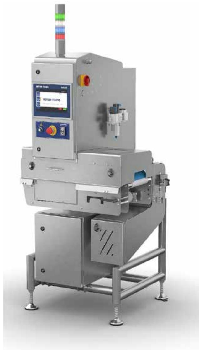
总而言之，梅特勒托利多 X34C 是一款快速高效的垂直照射的 X 射线检测系统，针对特定应用设置中单个产品的污染物检测进行了优化：流动包装的糖果、零食和谷物棒以及小包装面包。生产此类产品的制造商，无论是拥有多家工厂的跨国企业，还是拥有一条生产线的中小型企业，都将受益于其速度、更高的检测灵敏度和紧凑的占地。此外，梅特勒托利多 X 射线检测系统备受赞誉的易用性、久经考验的坚固性和可靠性也会让他们受益匪浅。◈
